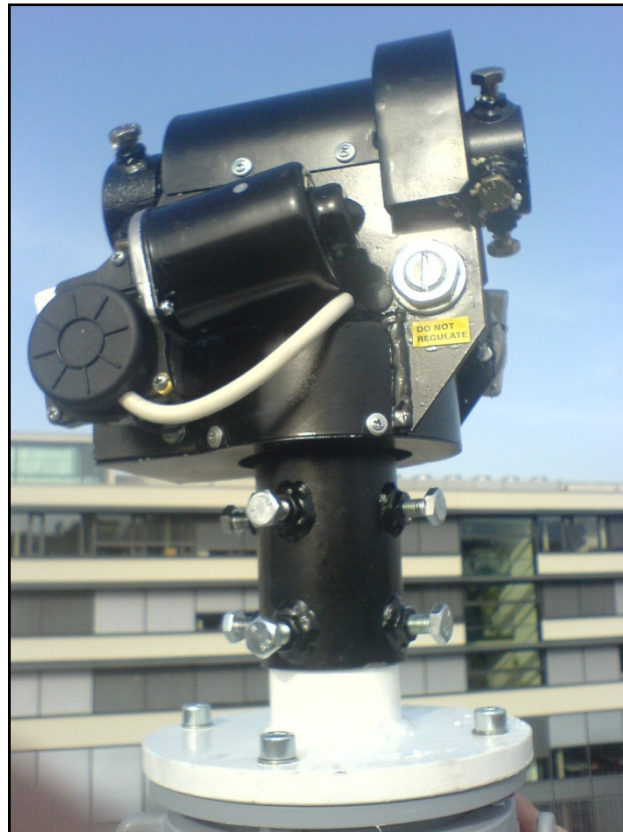
Figure 23 : Tête du mât avec la pièce d'adaptation et le moteur
